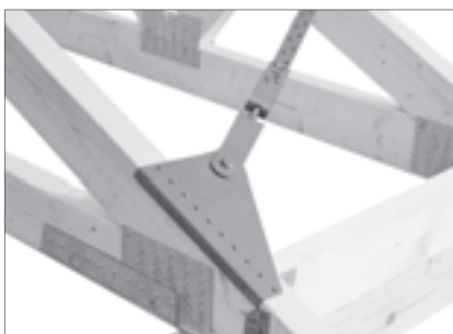
Detail am Traufpunkt: Bandanschluss BNF25 mit Spanngerät BNSP25 auf der Oberseite des Sparrens befestigt. Holzbreite: mind. 45 mm, max. 75 mm.
